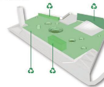
Se reutiliza el estacionamiento abierto existente como tal, la losa y su estructura que según informes es apta para ello y ciertos elementos estructurales verticales
